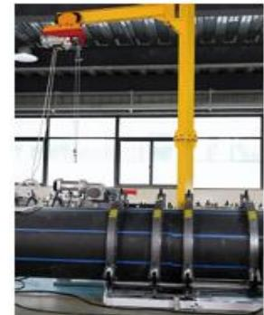
Izado (transportando el cortador y el calentador)
