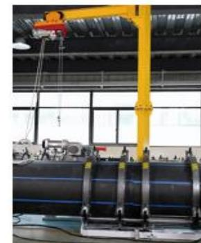
Izado (transportando el cortador y el calentador)
