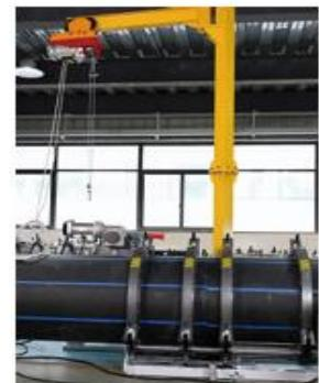
Izado (transportando el cortador y el calentador)
